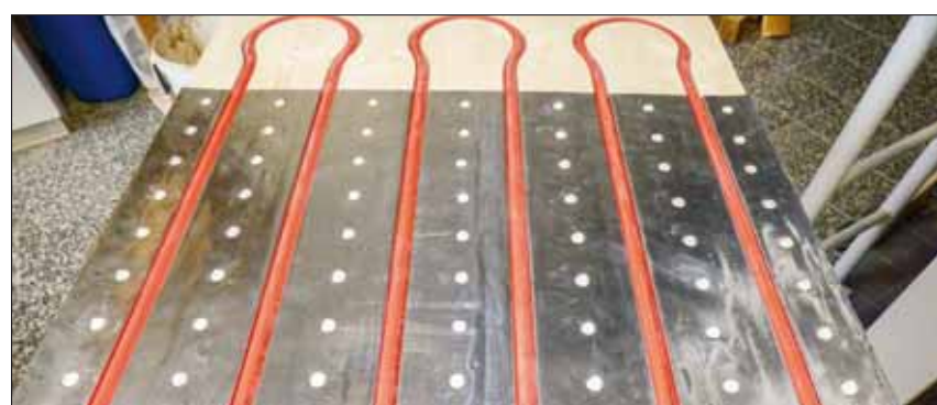
Abbildung 5 Raumtemperierelement mit Aluminiumfolie als Wärmeverteilschicht, Alufolie perforiert zur Verleimung zwischen Decklage und Trägerplatte
