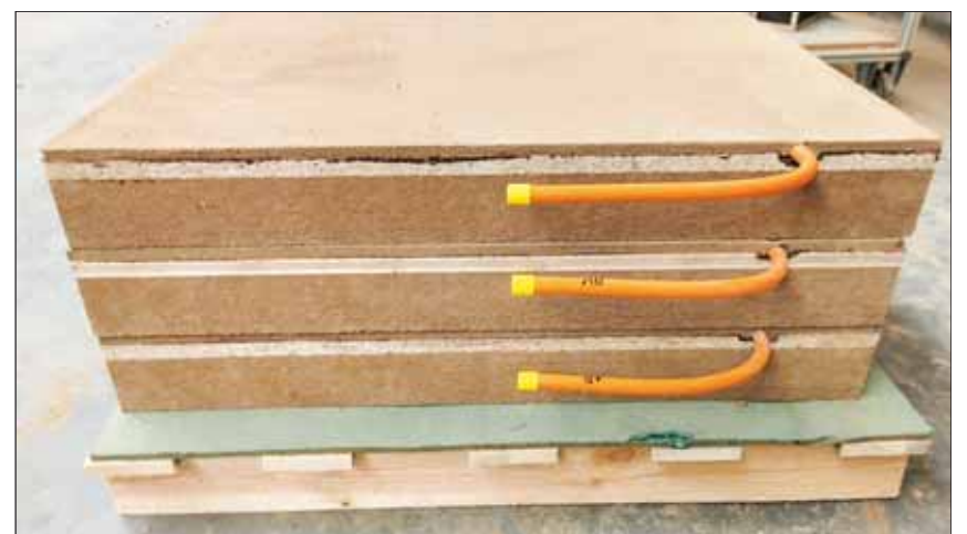
Abbildung 7 Raumtemperierelemente mit Lehmputz-Deckschichten verschiedener Variation; Trägerplatte Gipsspanplatte (unten) und Massivholzplatte (Mitte) mit jeweils optimierter Lehmischung; oben: Trägerplatte Gipsspanplatte mit Referenz-Lehmputz WEM UP (ohne Fasern)
