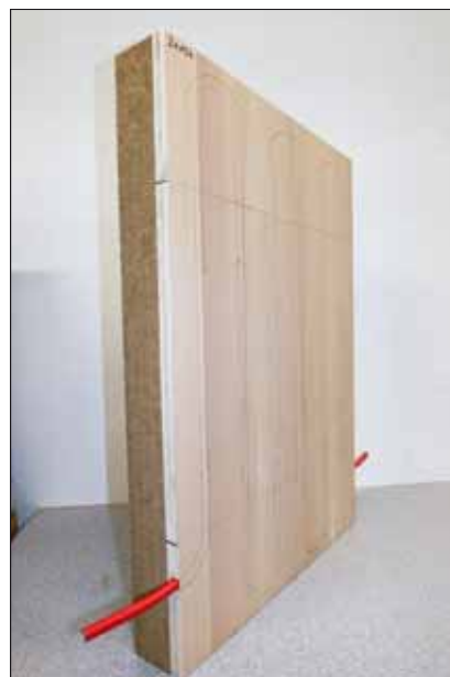
Abbildung 6 Raumtemperierelement mit perforierter Aluminiumfolie als Wärmeverteilschicht zwischen Trägerplatte und Buchen-Decklage
