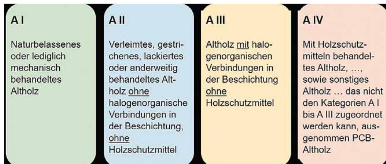
Abbildung 3 Vorsortierung nach Altholzverordnung (AltholzV). Es stellt sich die Frage, ob Schadstoffgehalte für eine richtige Zuordnung der Kategorien organoleptisch, also mit bloßem Auge, zweifelsfrei erkennbar sind.
