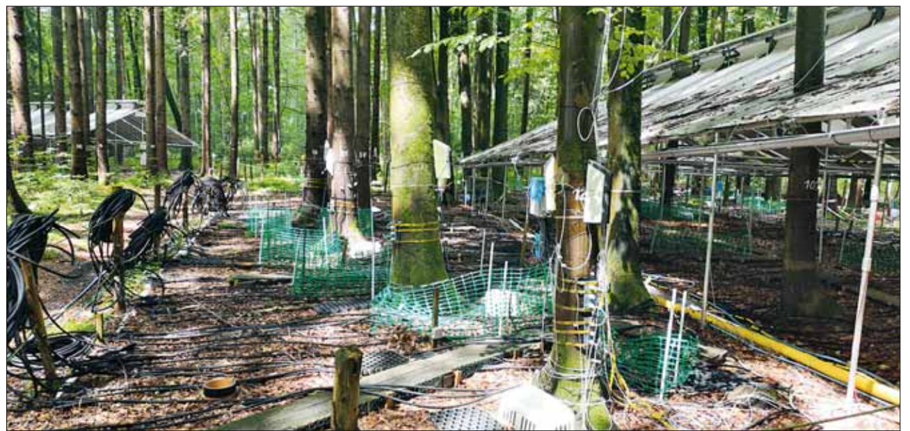
Der Wald als Untersuchungsgebiet: Die überdachte Fläche rechts hält Wasser von den Bäumen ab, links ist eine Kontrollfläche. Mit modernen Messinstrumenten lässt sich u. a. „hören“, dass Bäume typische Geräusche erzeugen, wenn sie unter Trockenstress geraten. Fotos: Universität Innsbruck
